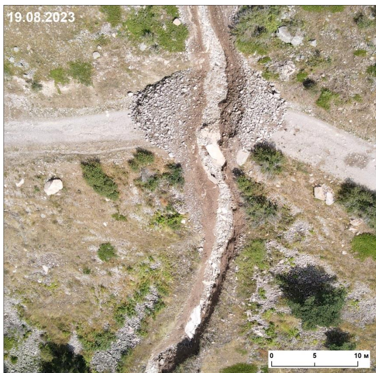
Рис. 2. Следы прохождения селя по левому притоку р. Чегем. Фото А.Р. Акаева
