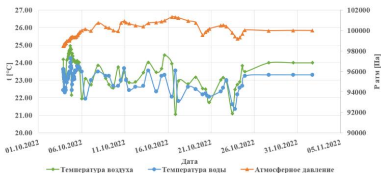
Рис. 10. Результаты регистрации температуры и атмосферного давления для оценки проницаемости (по данным автора)
