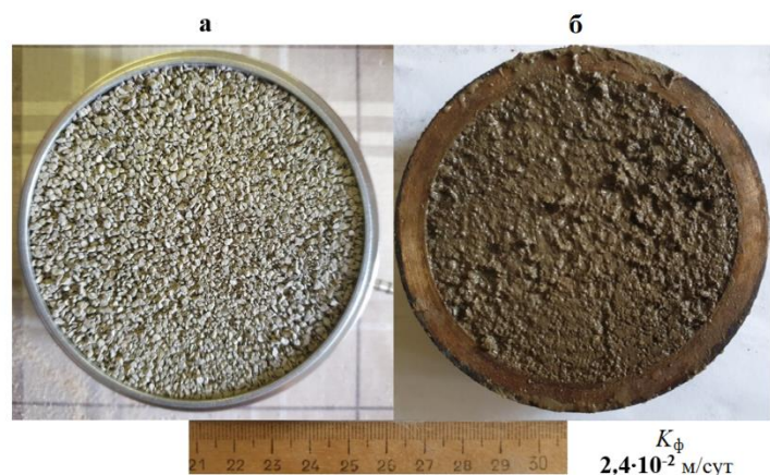
Рис. 4. Оценка K_f буферной засыпки (бентонитовая крупка) при уплотнении под давлением 60 кПа. Вид: а – после уплотнения; б – после фильтрации
