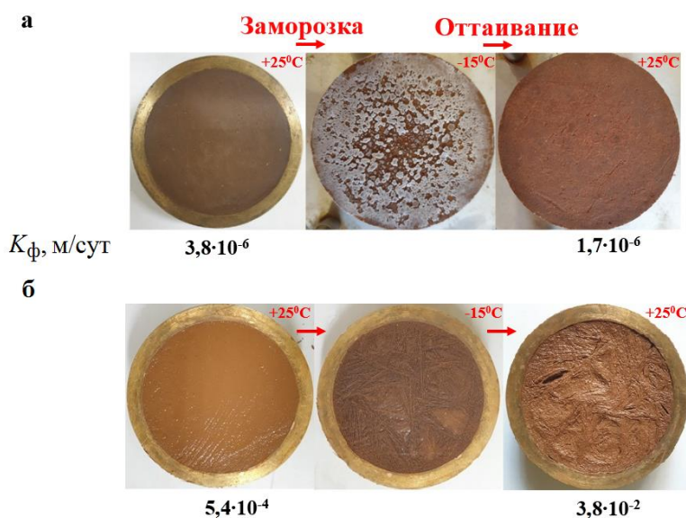
Рис. 3. Результаты изучения изменения K_f материалов глинистых барьеров безопасности при промерзании: а – уплотненная природная ожелезненная глина; б – суспензия на основе ожелезненной глины и бентонита
