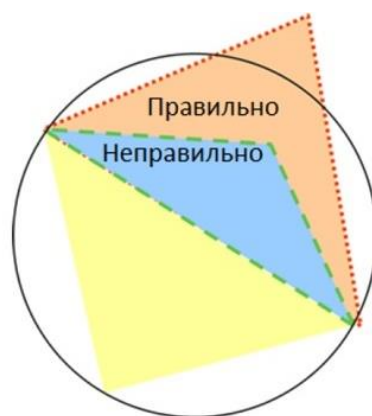
Рис. 2. Сетка: красный треугольник – удовлетворяющий критерию Делоне, синий треугольник – не удовлетворяющий критерию Делоне
