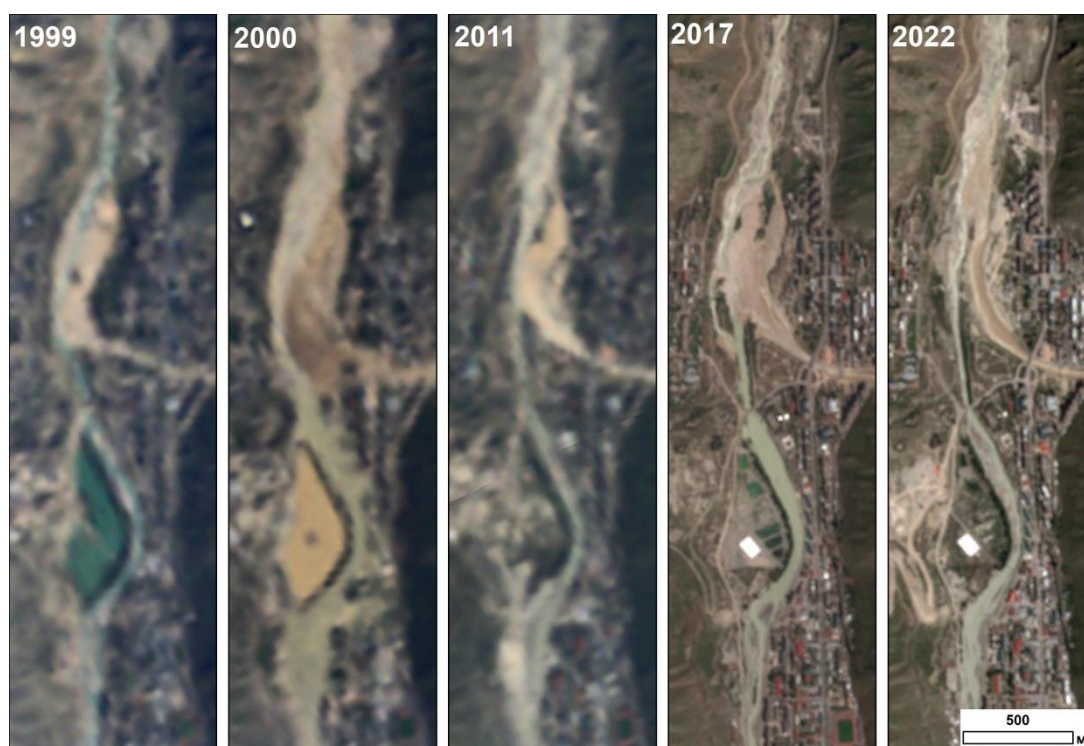
Рис. 3. Зона аккумуляции селей р. Герхожансу и формирования подпрудных озер на р. Баксан на космоснимках Landsat (1999–2011 гг.) и Sentinel-2 (2017 и 2022 гг.). Источник: https://apps.sentinel-hub.com/eo-browser
