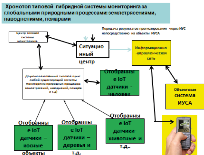
Рис. 2. Хронотоп типовой гибридной системы мониторинга за глобальными природными процессами: землетрясениями, наводнениями, пожарами
