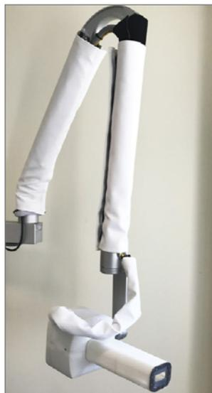
Рис. 1. Экспериментальная установка для внутриротового томосинтеза [3]
