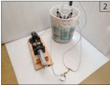
Рис. 2. Фотография общего вида установки. Слева - дозатор, справа - роторная машина в контейнере
