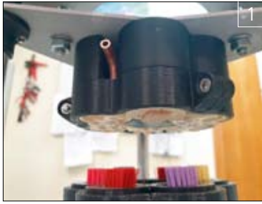
Рис. 1. Роторная машина для испытания материалов, используемых в стоматологии
