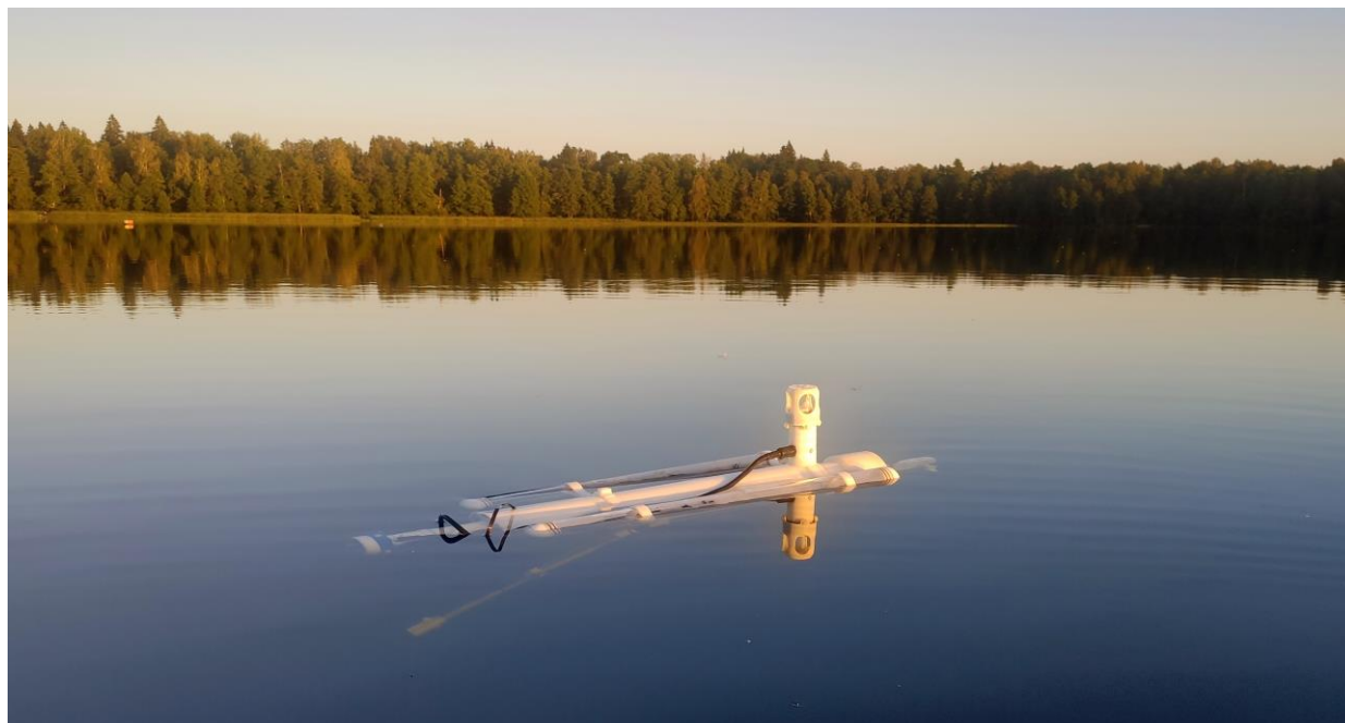
Рис.1. Привязной зонд-профилограф "Винчи" во время испытаний на оз. Глубокое
