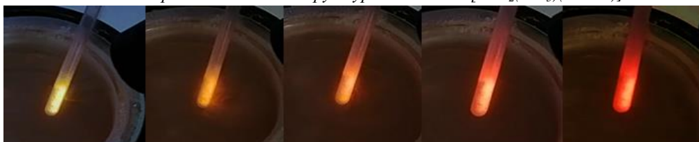
Рис. 2. Изменение цвета люминесценции комплексов [\text{Eu}_x\text{Tb}_{1-x}\text{L}_3(\text{H}_2\text{O})_2] при изменении температуры от 77 К до комнатной температуры
