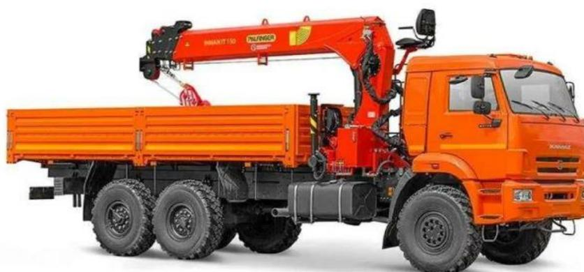
Рис.1 КамАЗ – 43118 с краново – манипуляторным устройством
