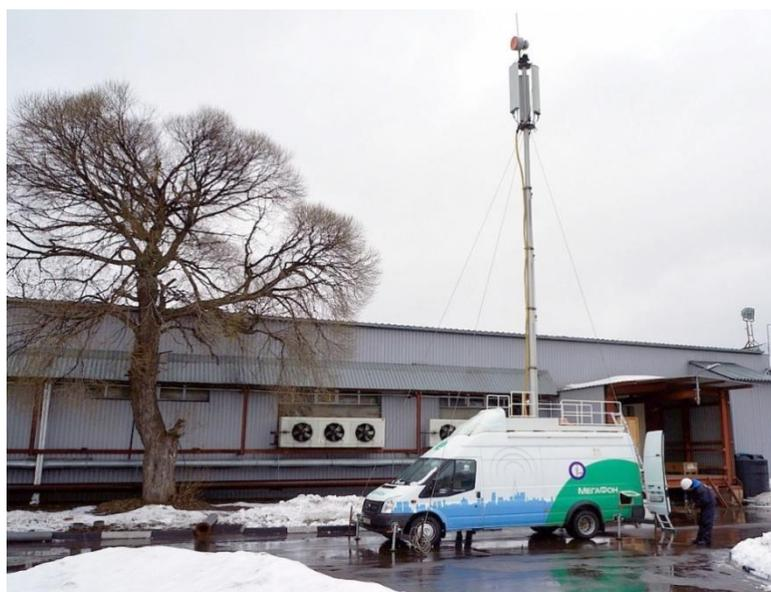
Рис. 1. Передвижная базовая станция на платформе Ford Transit
