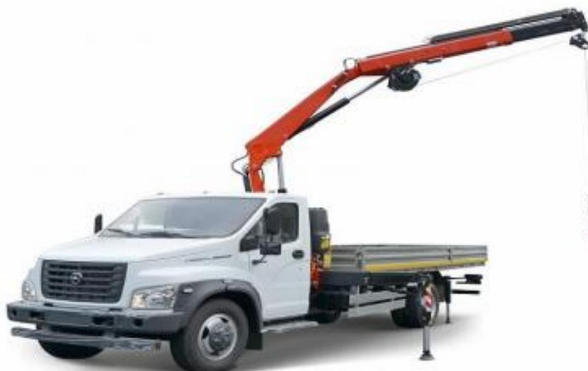
Рис.2 ГАЗон Next с краном – манипуляторным устройством
