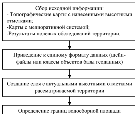
Рис. 1. Алгоритм построения водосборной площади магистрального канала
