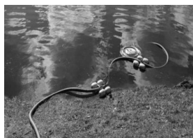
Рис.4. Олеофильный скиммер MINIMAX-20
