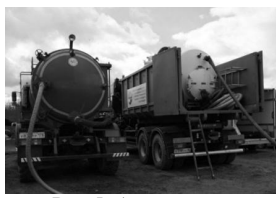
Рис.5. Автомшины для хранения и транспортировки ННП с вакуумными установками
