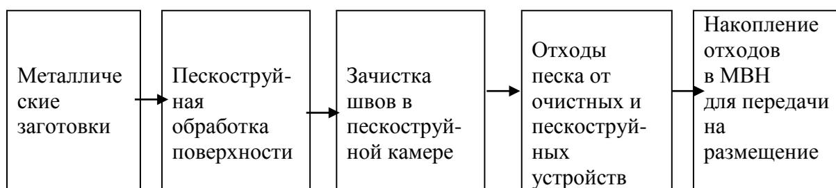
Рис. 1. Блок-схема образования отходов абразивных материалов
