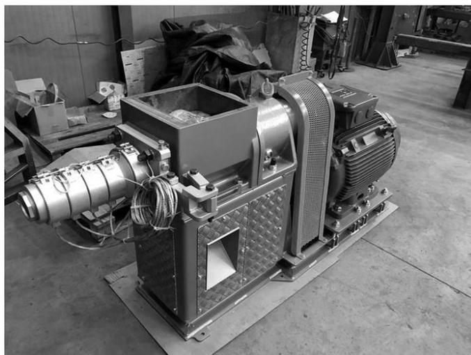
Рис. 1. Экструдер для получения древесных брикетов по технологии [11], экспонированный на выставке Лигна 2019 (Ганнове). Производитель – INOS (Рига)
