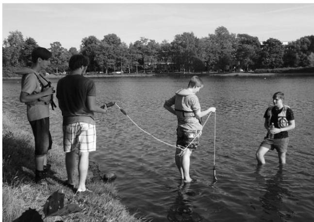
Рис. 3. Измерение концентрации растворенного кислорода на поверхности воды Сестрорецкого водохранилища участниками летней Биос-школы
