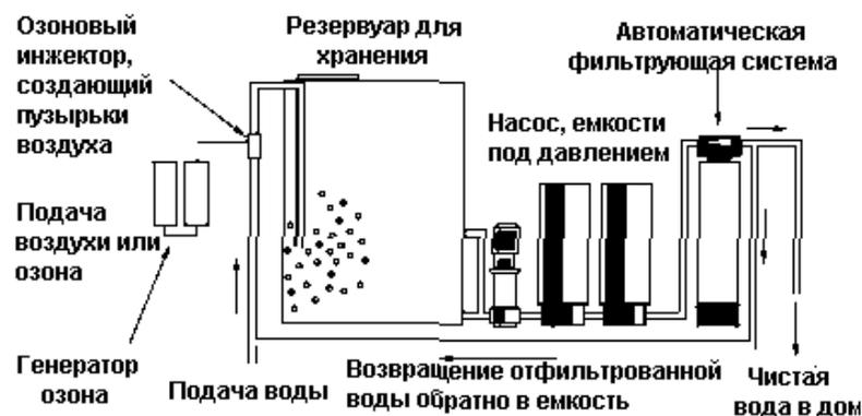
Рис. 1. Пример установки Озонового обеззараживания воды.
