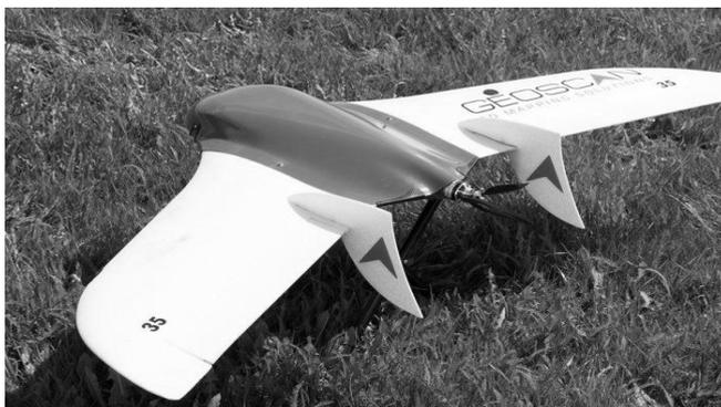
Рис. 2. БПЛА самолетного типа Geoscan
