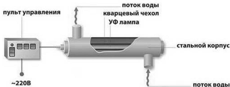
Рис. 2. Пример установки Ультрафиолетового обеззараживания воды.
