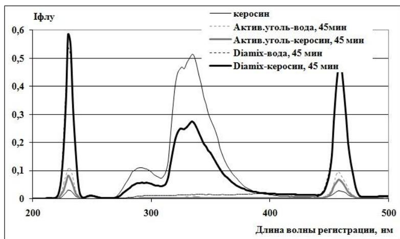
Рис. 4. Спектрофлуориметрический анализ проб деkantированной жидкости после контакта водного раствора керосина и дистиллированной воды с материалом Diamix aqua и активированным углем. Длина волны возбуждения флуоресценции 230 нм
