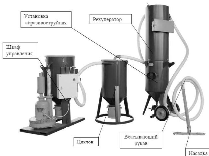
Рис. 2. Система сбора и регенерации абразива СОВ – 4
