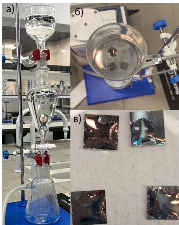
Рис. 3. Перенос плёнок наночастиц методом drain-to-deposit: а) общий вид установки для переноса плёнок; б) расположение подложек под плёнкой; в) кремниевые подложки с перенесённой плёнкой
