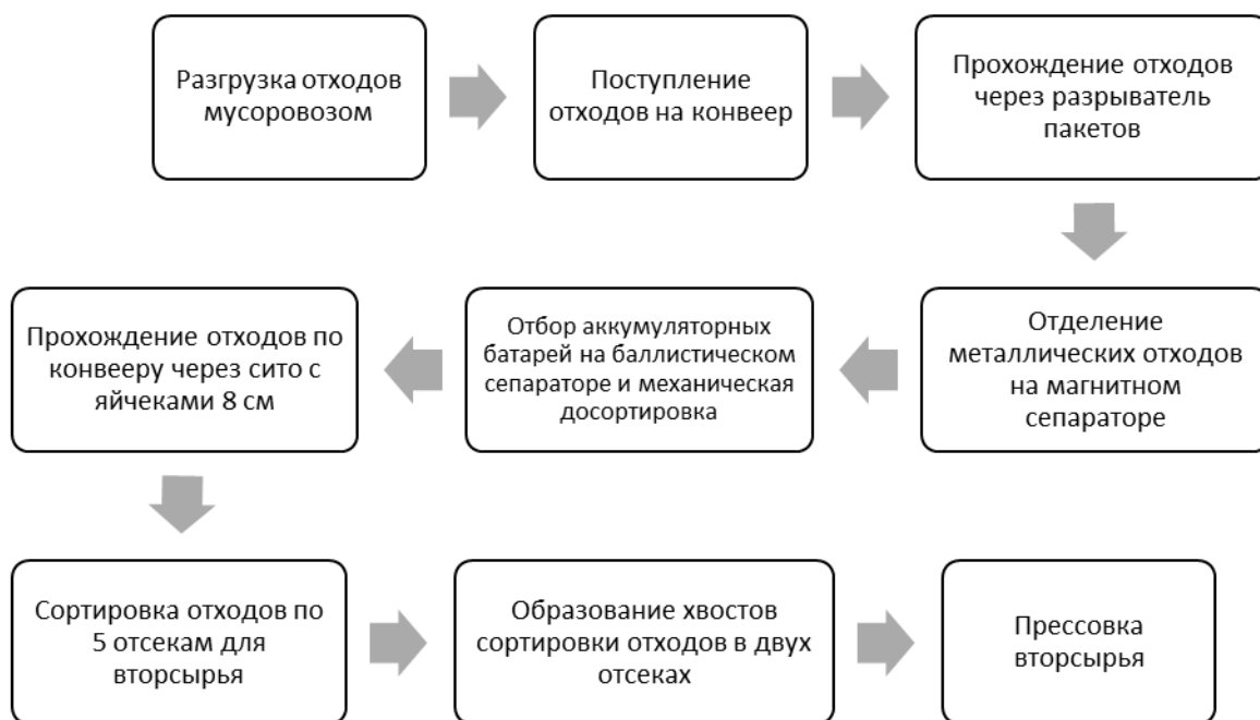
Рис. 2. Блок-схема линии сортировки отходов
