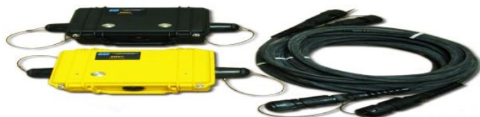
Рисунок 1 – Внешний вид БИКС (генератор, приемник, емкостные шлейфы)
