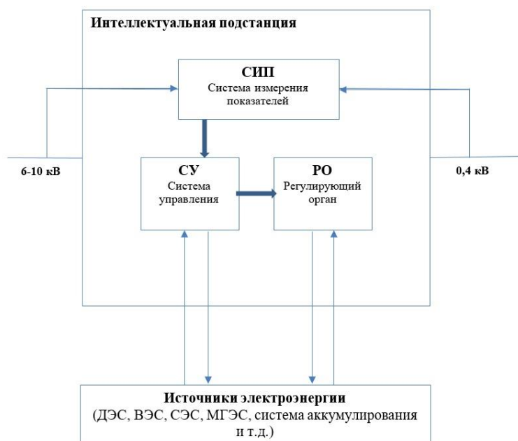
Рис. 5. Структурная схема интеллектуальной подстанции
