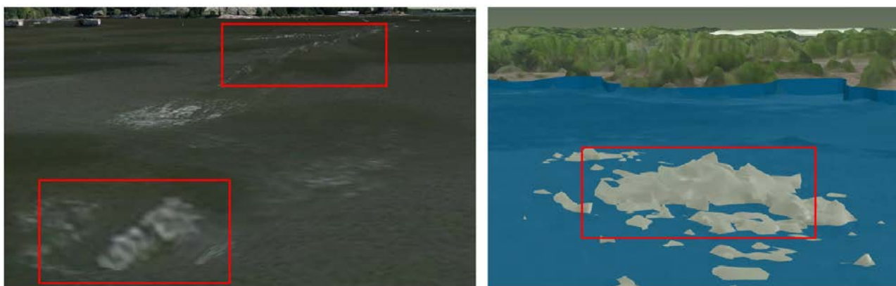
Рисунок 1. Ошибки в полигональной модели на объекте гидрографии (слева – модель г. Хельсинки, справа – модель г. Томск), составлено автором по [2, 4]
