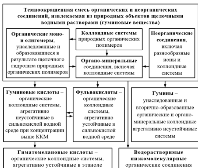
Рис. 2. Существующая схема разделения темноокрашенной смеси органических и неорганических соединений (гуминовых веществ), извлекаемой из природных объектами щелочными водными растворами.
