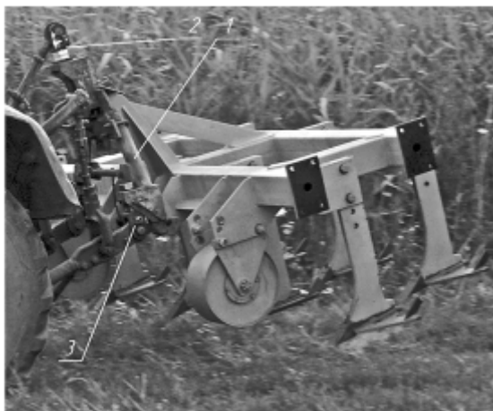
Рис. 1. Динамометрическая рама и тензодатчики: 1 — динамометрическая рама; 2, 3 — тензозвенья
