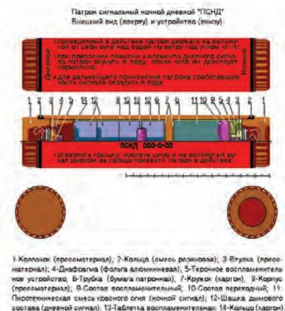
Рис 2. Устройство фальшфейера.
