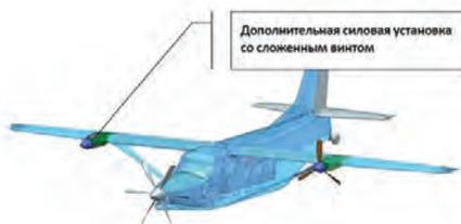
Рисунок 4. Гибридная силовая установка самолета ЛМС - 901.
