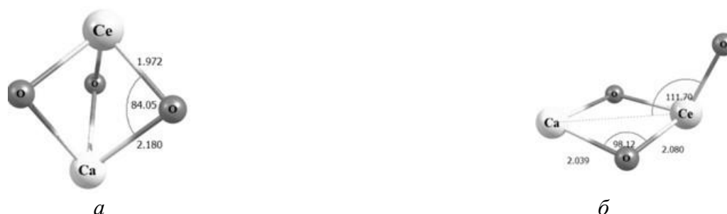
Рисунок 1 – Структуры молекулы \text{CaCeO}_3 – а) \text{C}_{3v} , б) \text{C}_s . Расчет проводился по методу MP2(Full)
