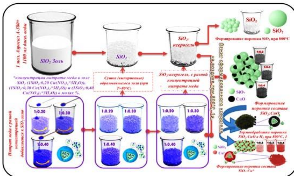
Рисунок 1 – Основные технологические этапы получения микропорошков состава \text{SiO}_2:\text{CuO} и \text{SiO}_2:\text{Cu}^0 , формируемых на основе аэросила марки А-380
