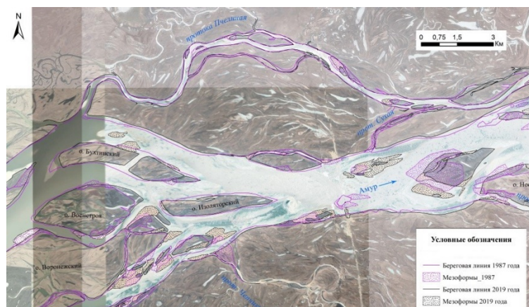
Рис. 3 Фрагмент схемы плановых деформаций исследуемого участка русла р. Амур, линии бровок поймы и островов по состоянию на 1987 г. и 2019 г.
