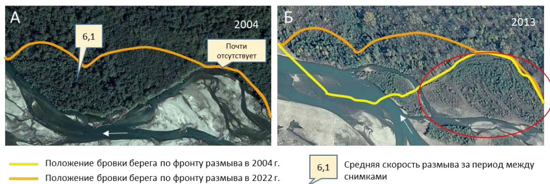
Рис. 2 Результат сопоставления спутниковых снимков р.Лабы: А – положение бровки правого размываемого берега за 2022 г. на снимке 2004 г.; Б – положение бровок размываемых берегов 2004 и 2022 гг. на снимке 2013 г.
