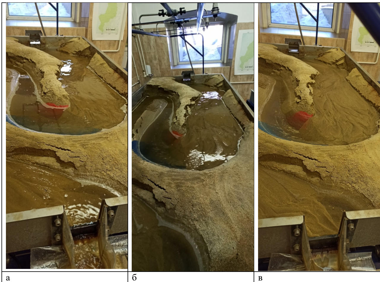
Рис. 3 Эксперимент с наклонной моделью меандра реки: а – наклон 3%, б – наклон 5%, в – вид русла по окончании эксперимента и удаления воды.
