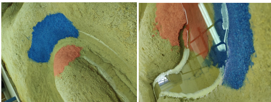
Рис. 1 Эксперименты по исследованию размыва меандра.
