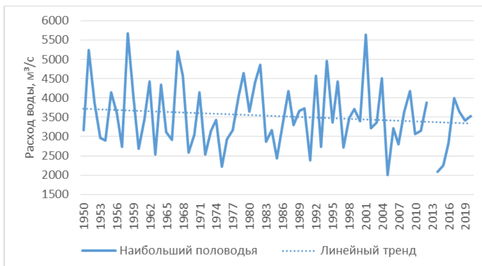
Рис. 4 Изменение наибольшего расхода воды половодья на реке Большой Патом (с. Патома).
