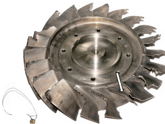
Рис. 1. Вид блиска первой ступени ВСУ ТА12-60. Стрелкой показано место отделившейся лопатки.
