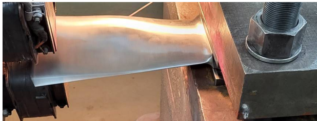
Рис. 4. Рабочая лопатка, установленная на стенде, для проведения усталостных испытаний.
