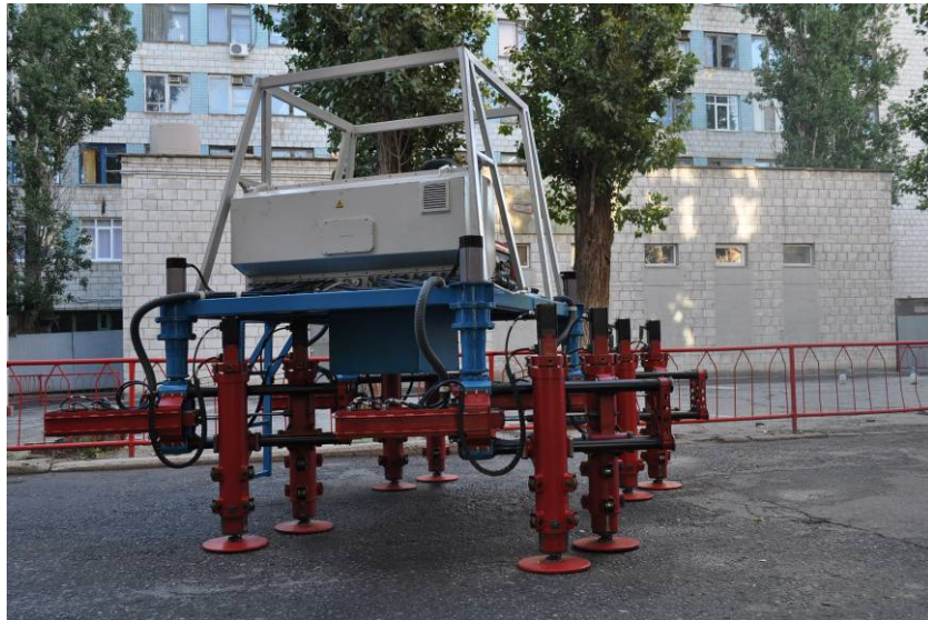
Рис. 1. Шагающий робот «Ортоног».
