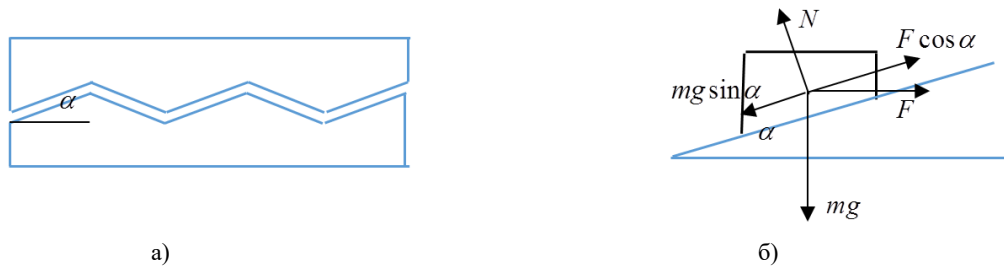
Рис. 2. Схема модели скольжения по шероховатостям.
