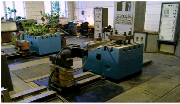
Рис. 1. Общий вид электромагнитного вибростенда. Рис. 2. Принципиальная схема соединения аппаратуры электромагнитного вибростенда.
