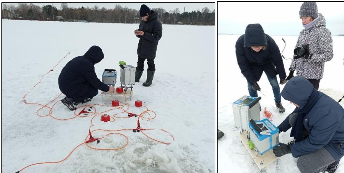
Рис. 1. Процесс установки гравиметров CG-5 и CG-6 Autograv на деревянную платформу. Рядом располагаются 4 сейсмоприемника (полевые модули ТЕЛСС-403) и дифференциальная GPS-система
