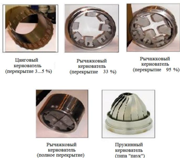
Рис. 3. Варианты конструкций кернорвателей производства Российской Федерации
