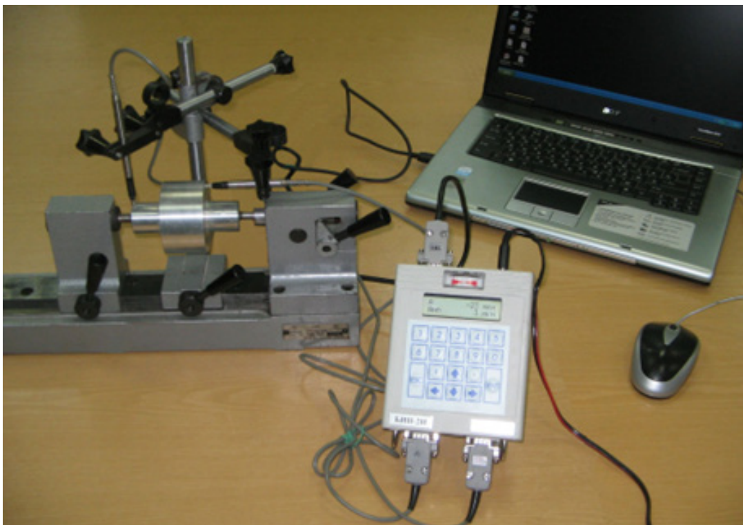
Рисунок 2. Измерение одновременно радиального и торцевого биений
