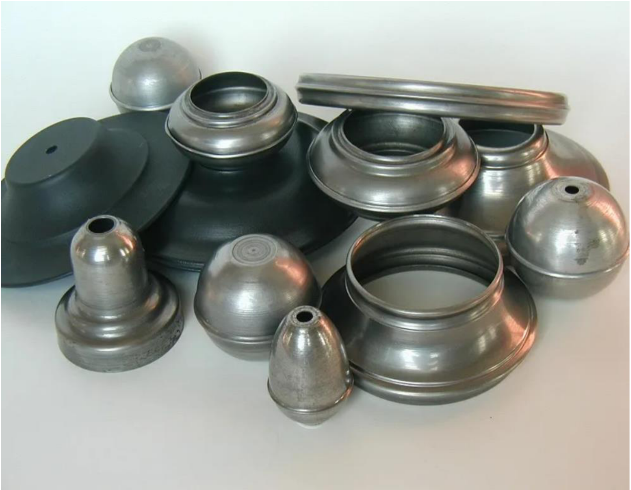
Рисунок 2 – Примеры деталей, получаемых ротационной вытяжкой
