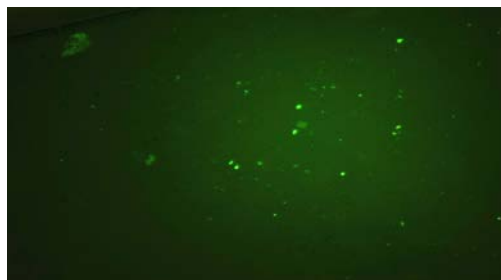
Рис. 1. Микрофотография флуоресценции антител на поверхности графена 5x5 мм,
