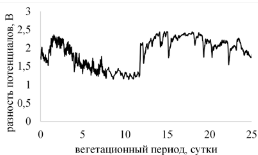
Рис. 1. Динамика разности потенциалов в корнеобитаемой среде салатов в 20-ти БЭС, соединенных последовательно.
