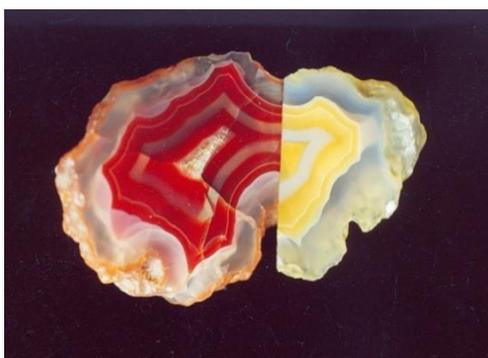
**Рис.1.** Концентрически-зональный агат: справа – исходный, слева – термообработанный
