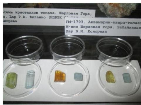
**Рис. 2.** Аквамарины (справа), полученные методом автоклавной обработки желто-зеленых бериллов (слева)
