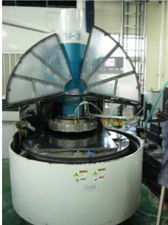
Рис. 5. Станок для утонения стеклянных подложек дисплейных панелей с помощью кольцевого алмазного инструмента.
