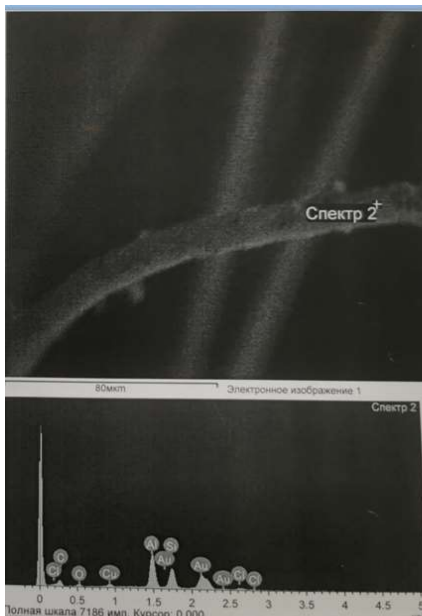
Рисунок 2 - Фотографии изображения нити и рентгено-спектрального анализа поверхности нити с гетероструктурным покрытием.
