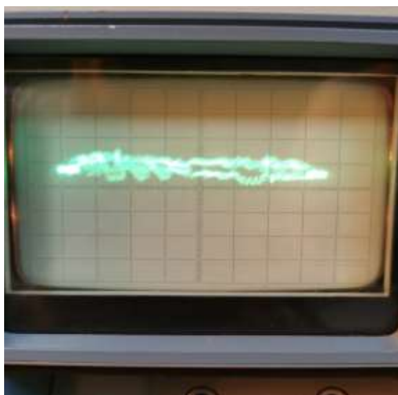
Рисунок 9 - ВАХ образца полимерной нити без покрытия.
