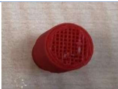
Рис. 4. Незавершенная часть из-за отсутствия филманета
