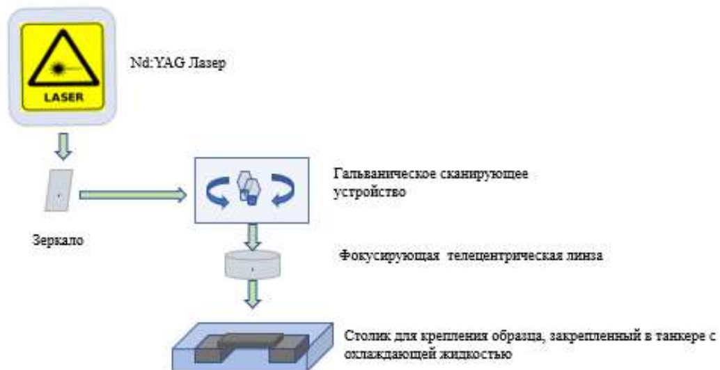
Рис. 3. Упрощенная схема технологического процесса сверления подложки карбида кремния толщиной 0,4 мм с нанесенным эпитаксиальным слоем с применением метода ЛИИОМ.
