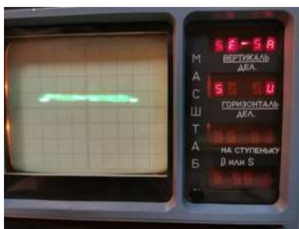
Рисунок 12 - ВАХ образца полимерной нити с гетероструктурным покрытием.
