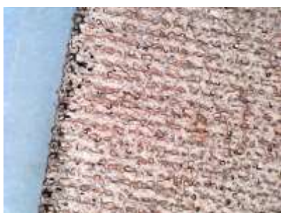
Рис. 8. Микроскопический анализ слоя меди с увеличением \times 60
