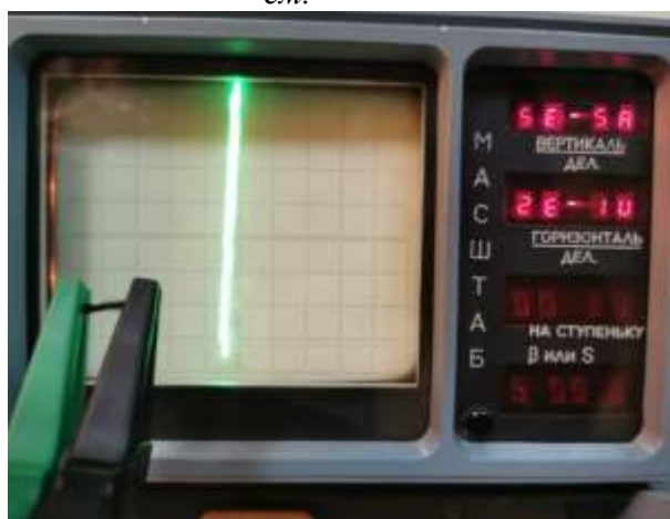
Рисунок 11 - ВАХ образца полимерной нити с металлическим покрытием длиной 1 см.
