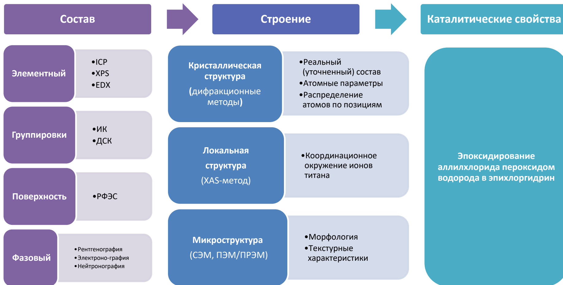
Рис. 1. Методология изучения цеолитов для установления фундаментальной связи «состав – строение – свойство»
