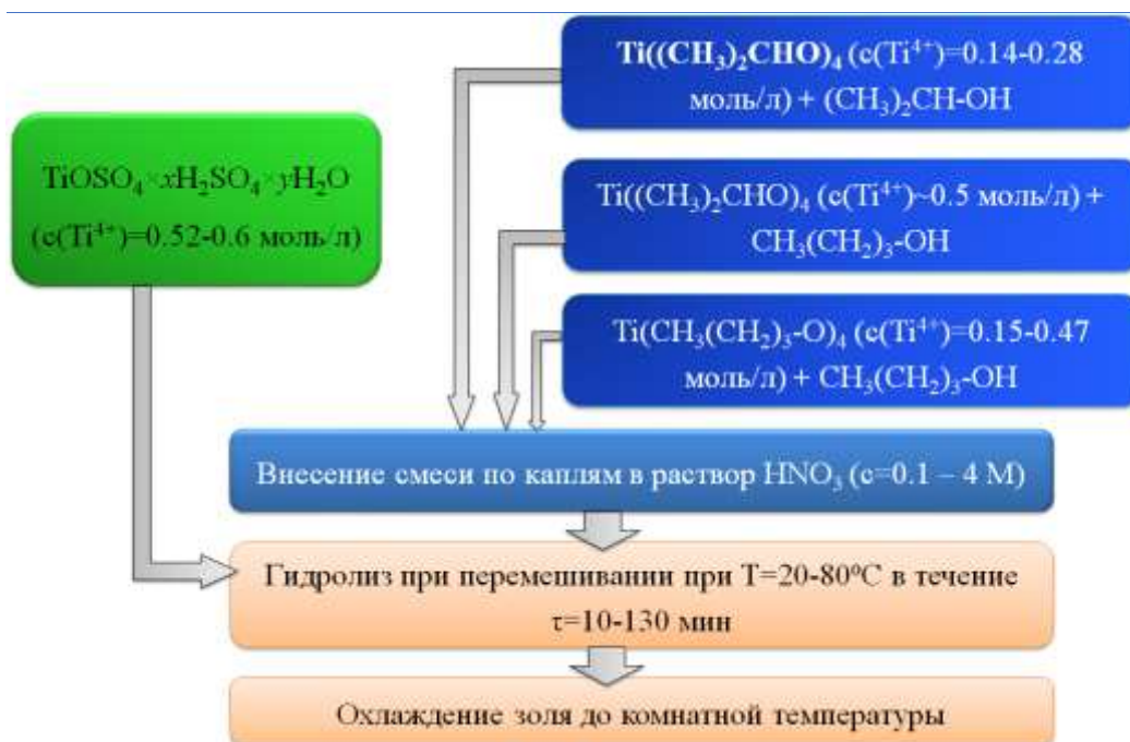
Рис. 1. Синтез золь с наноразмерным диоксидом титана.
