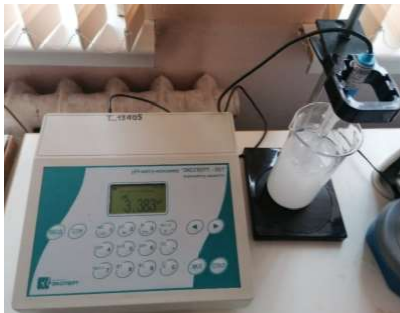
Рисунок 2 – Установка для потенциометрического определения рН
