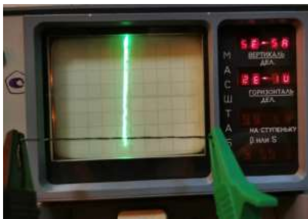
Рисунок 10 - ВАХ образца полимерной нити с металлическим покрытием длиной 10 см.
