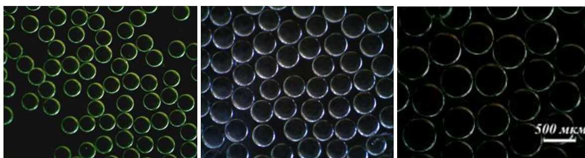
Рис. 1. Микрофотографии эмульсий, полученных при различных соотношениях объемных расходов матрицы и дисперсной фазы.
