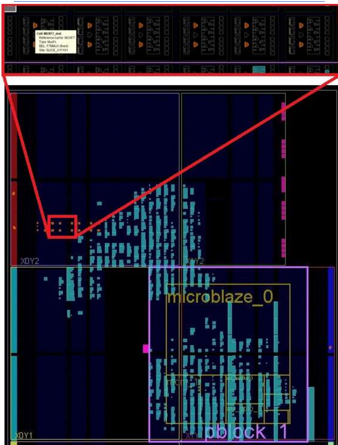
Рисунок 3. Результат имплементации проекта на кристалл ПЛИС. Вверху на выноске показан фрагмент цепочки специального устройства арбитр с фиксированным положением.
