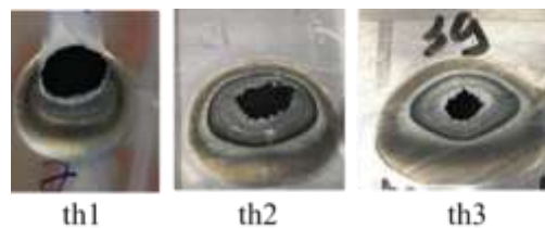
Рис.4. Изменение формы отверстия, образующегося в алюминии, при увеличении толщины ( th1 < th2 < th3 )
