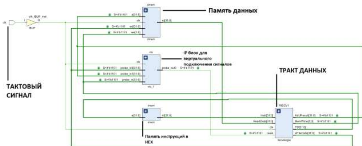
Рисунок 9. Итоговая RTL схема ядра процессора RISC-V
