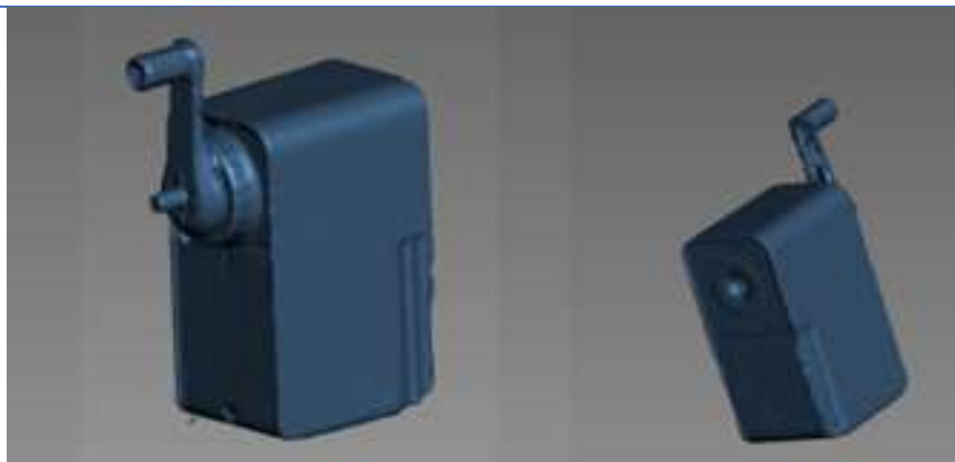
Рис. 2. Результат сканирования 3D-сканером Simscan 30
