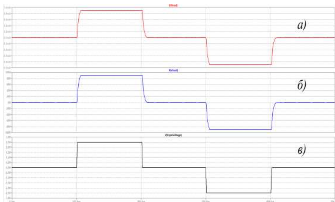
Рисунок.4. Результаты моделирования формирователя двуполярных импульсов напряжения ( a – ток в нагрузке; б – напряжение на нагрузке; в – входное напряжение высоковольтного усилителя)
