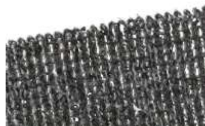
Рис. 10. Микроскопический анализ обратной стороны слоя меди с увеличением \times 120
