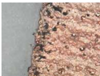
Рис. 9. Микроскопический анализ слоя меди с увеличением \times 120
