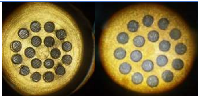
Рис.3.2.1 Уход каналов управляющего электрода относительно катодов
