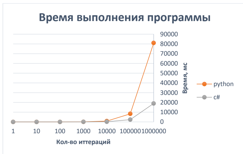
График зависимости времени расчетов в программах, реализованных на языках программирования C# и Python, от количества итераций.
