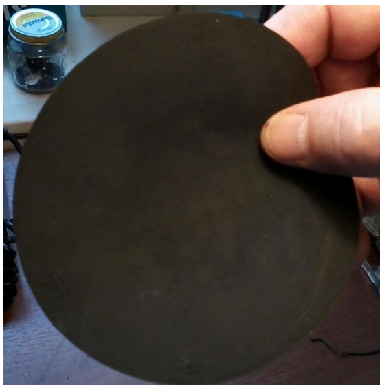
Рис.1. Типичный образец нанобумаги для электрохимических измерений.
