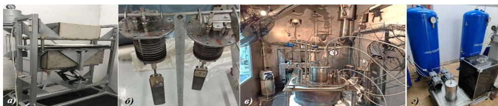
а – установка изготовления инертных керамических анодов; б. – инертные керамические аноды; в – макет электролизёра в инертной камере в ходе испытаний; г – макет установки по регенерации (очистки от кислорода) анодных газов электролизёра
