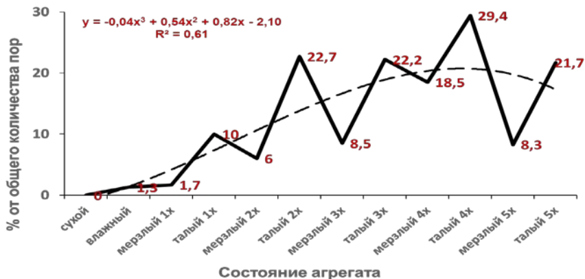
Рис. 5. Содержание пор с округлыми срезамы ( 8 < F^* \leq 1 ) в первых пяти циклах опыта. F^* = (4\pi S/P^2 + D/L)/2 , где S - площадь плоского среза поры, P - его периметр, D и L ширина и длина описанного вокруг среза поры прямоугольника.
