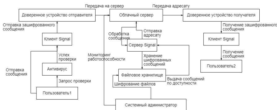
Рис. 1. Принцип работы защищенного канала связи компании.
