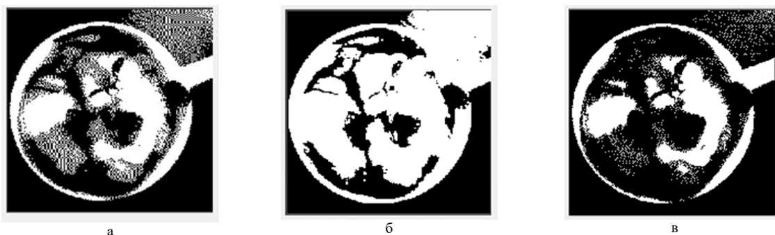
Рис. 1. Пример выполнения дилатации и эрозии с использованием функции strel : а – исходное бинарное изображение; б – дилатация; в – эрозия
