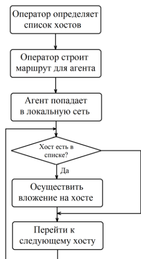
Рис. 4. Алгоритм распространения ПА в распределенной информационной системе со списком попаданий
