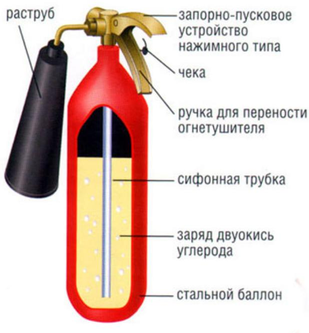
Рисунок 1 – конструкция углекислотного огнетушителя.
