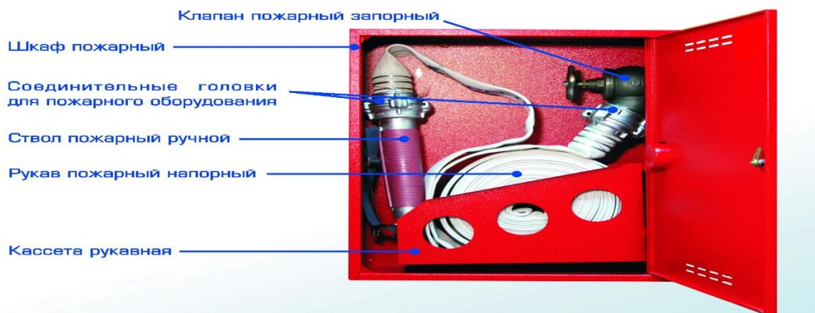
Рисунок 2 – пожарный ящик с рукавом, устанавливаемый в многоэтажных домах
