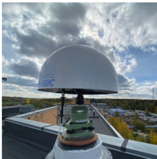
Рис. 4. Внешний вид НАП ГЕО-РС [19]: а – блок референсной станции ГЕО-РС АО «КБ НАВИС»; б – блок референсной станции ГЕО-РС, панель с разъёмами; в – антенна референсной станции ГЕО-РС [19]
