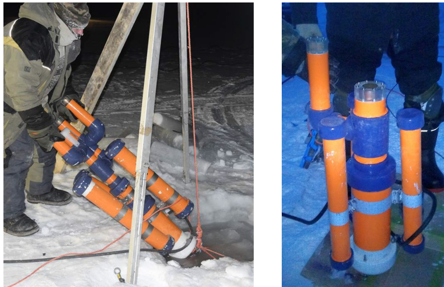
Рис. 2. Фотографии подводных гидролокаторов «Трезубец» (слева) и «Трезубец-2» (справа) перед установкой
