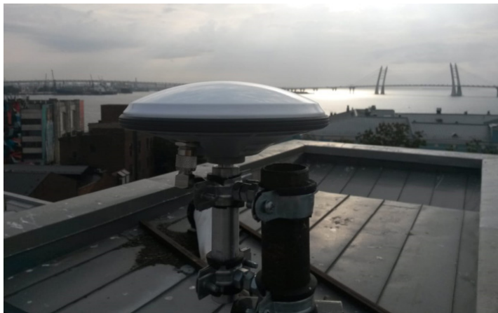
Рис 13. Антенна «ОС-113» на центре Опорного пункта «POIN» АО ГНИНГИ
