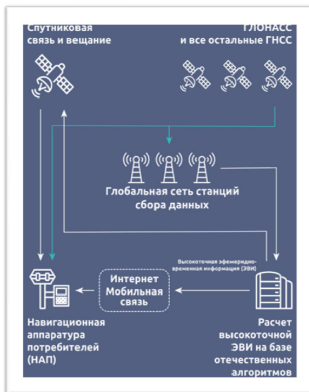
Рис. 3. Принципиальная схема «Сервиса высокоточной спутниковой навигации по технологии PPP» компании АО «ГЛОНАСС» [16]. Объяснение – в тексте
