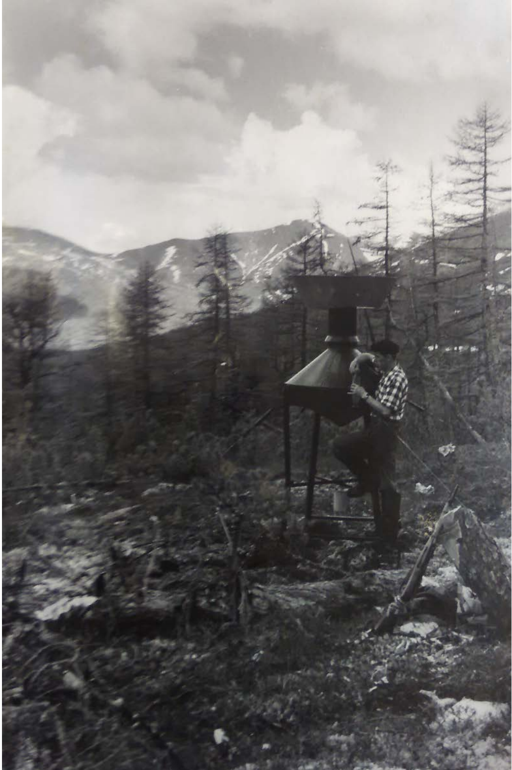
Рис. 11 Измерение осадков на суммарном осадкомере, 1960
