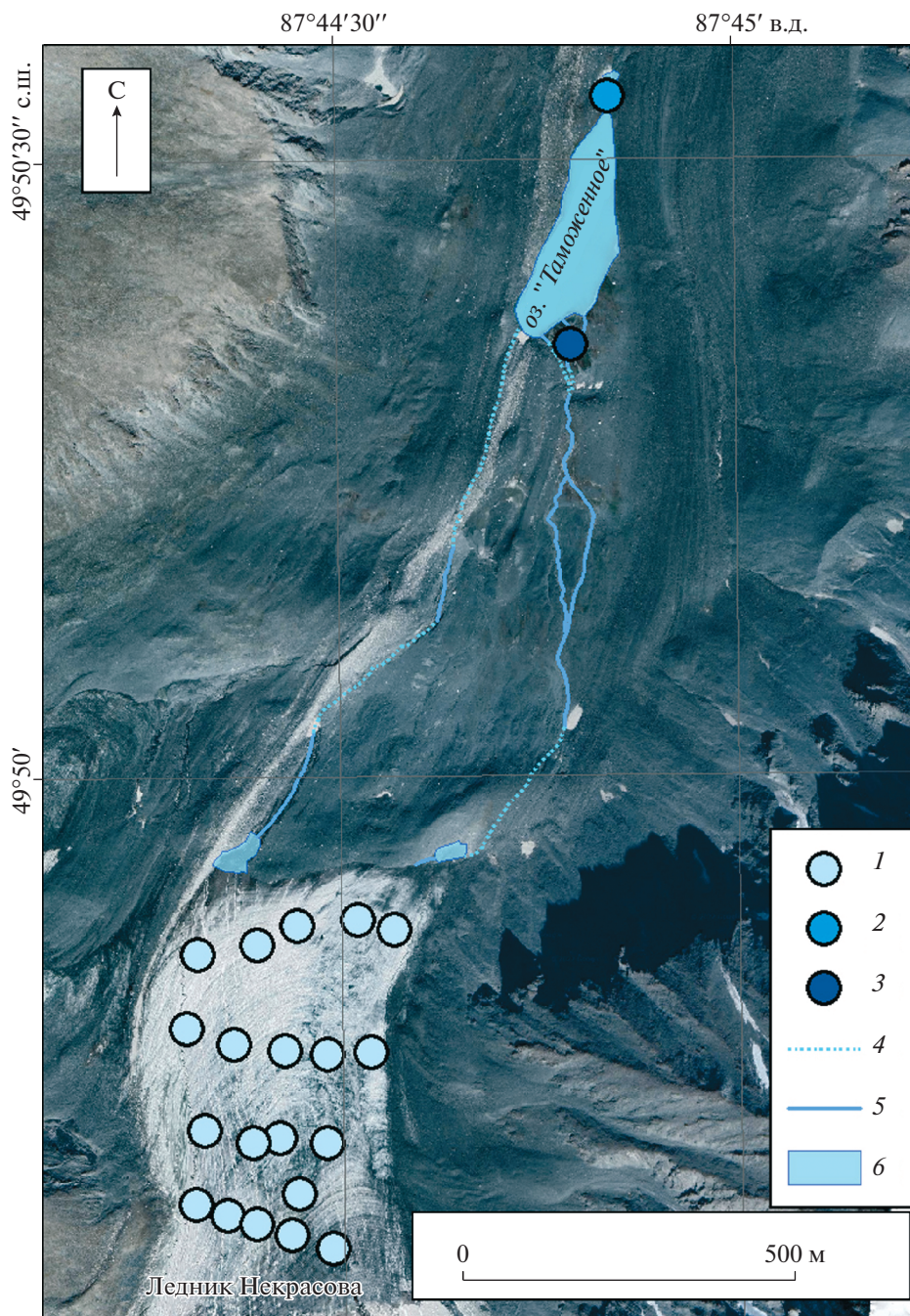
Рис. 2. Карта-схема мест отбора проб в системе ледник Некрасова – оз. Таможенное: 1 – пробы ледникового льда, 2 – ручей, вытекающий из озера, 3 – ручей, втекающий в озеро, 4 – потоки воды, фильтрующиеся через морену, 5 – ручьи на поверхности, 6 – озера.
