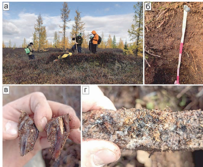
Рис. 16. а) Заложение почвенного разреза на торфяном бугре (фото В.С. Исаева), б) профильное строение бугра, в), г) льдистая мерзлота со слабо разложившимися растительными остатками (фото Гинзбург А.П.).
