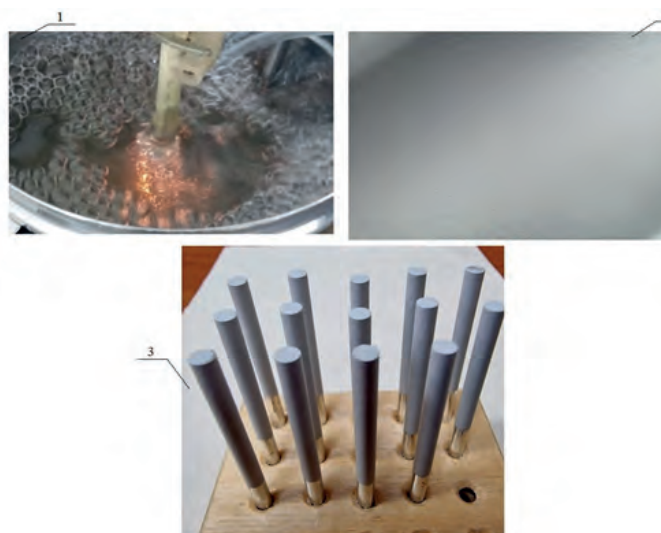
Рис. 3. Изготовление диэлектрического пористого слоя чувствительного элемента методом МДО 1 – фаза МДО; 2 – пленка МДО под увеличением в микроскопе; 3 – пленка МДО нанесенная на подложку
