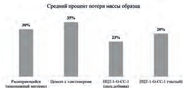
Рис. 1. Лабораторные испытания по оценке степени растворения цементного камня в кислоте соляной ингибированной 15 %
