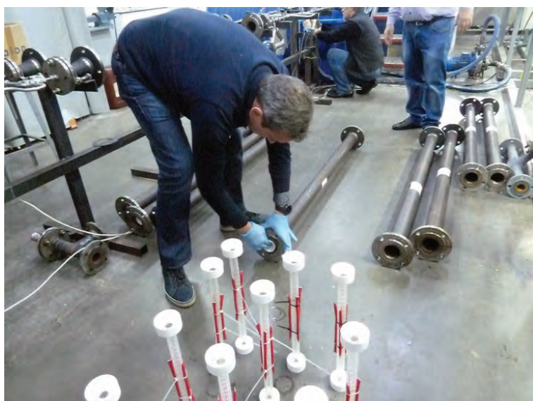
Рис. 7. Установка трассерной системы (нефть+вода+газ) в исследовательские вставки стенда
