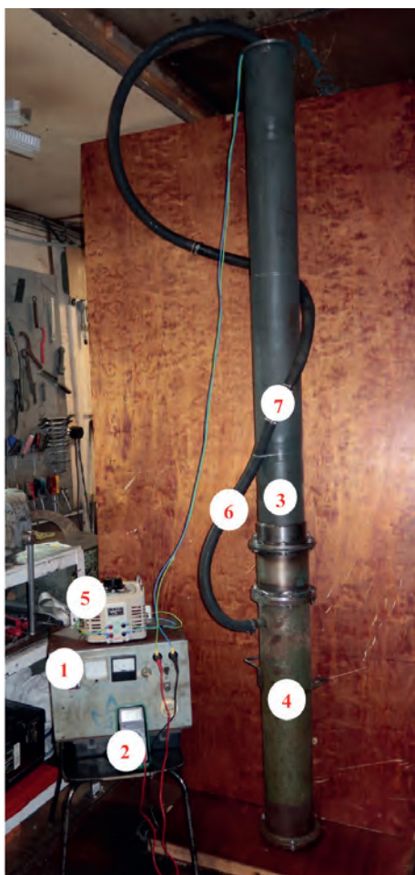
Рис. 4. Экспериментальный стенд для определения расхода и гидравлических сопротивлений теплоносителя в термогидравлическом буровом снаряде-расширителе 1 - пульт управления, 2 - мультиметр, 3 - верхняя труба, 4 - нижняя труба, 5 - ЛАПР, 6 - шланг, 7 - расходомер
