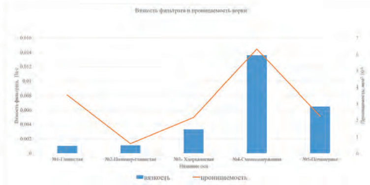
Рис. 2. Вязкость фильтрата и проницаемость корки
