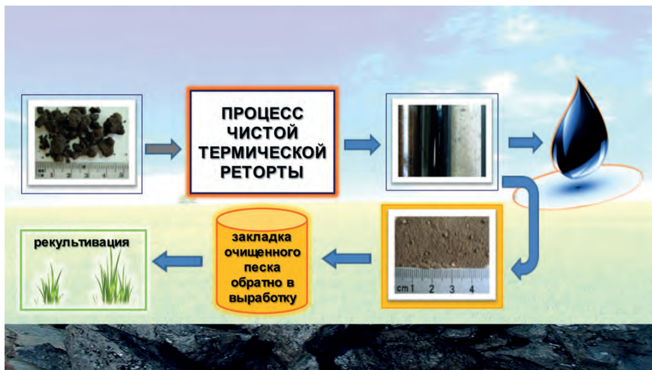
Рис. 6. Схематизация этапов процесса чистой термической реторты
