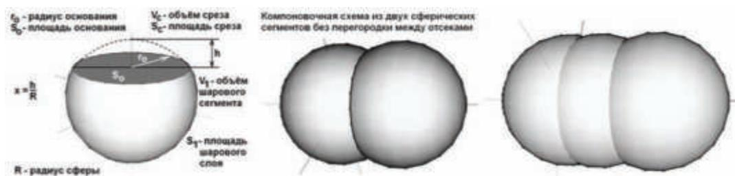
Рис. 1. Примеры компоновки корпуса КА из сферических сегментов
