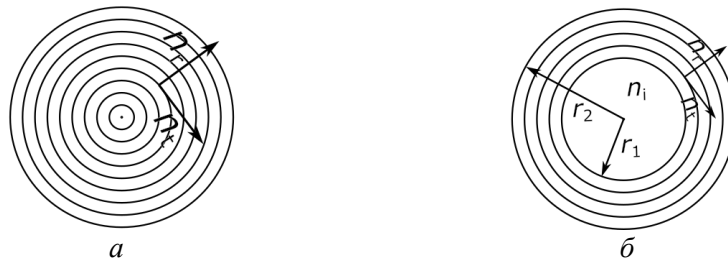
Рис. 1. Сфера с радиальной анизотропией (а); структура ядро–оболочка (б) с изотропным ядром с радиусом r_1 и показателем преломления n_i и с радиальной анизотропной оболочкой r_2 и радиальным и тангенциальным показателями преломления n_r и n_t соответственно
