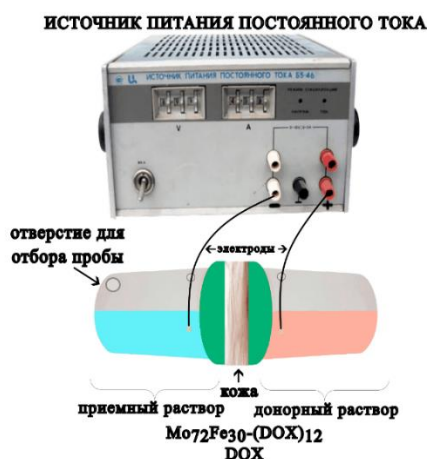
Рисунок 2. Схема электрофоретической установки
