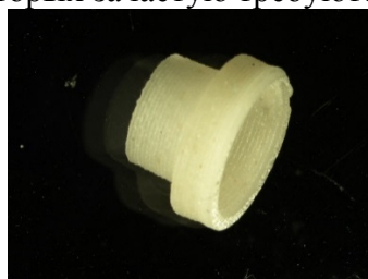
Рис. 1. Втулка из стеклогерметика, изготовленная методом 3D печати.
