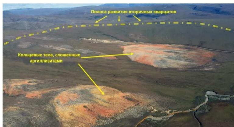
Рис. 2 - Вид с вертолета. Аргиллизитовые «шляпы» рудопроявления Комплексное, Кайэнмываамский рудный узел, Центральная Чукотка
