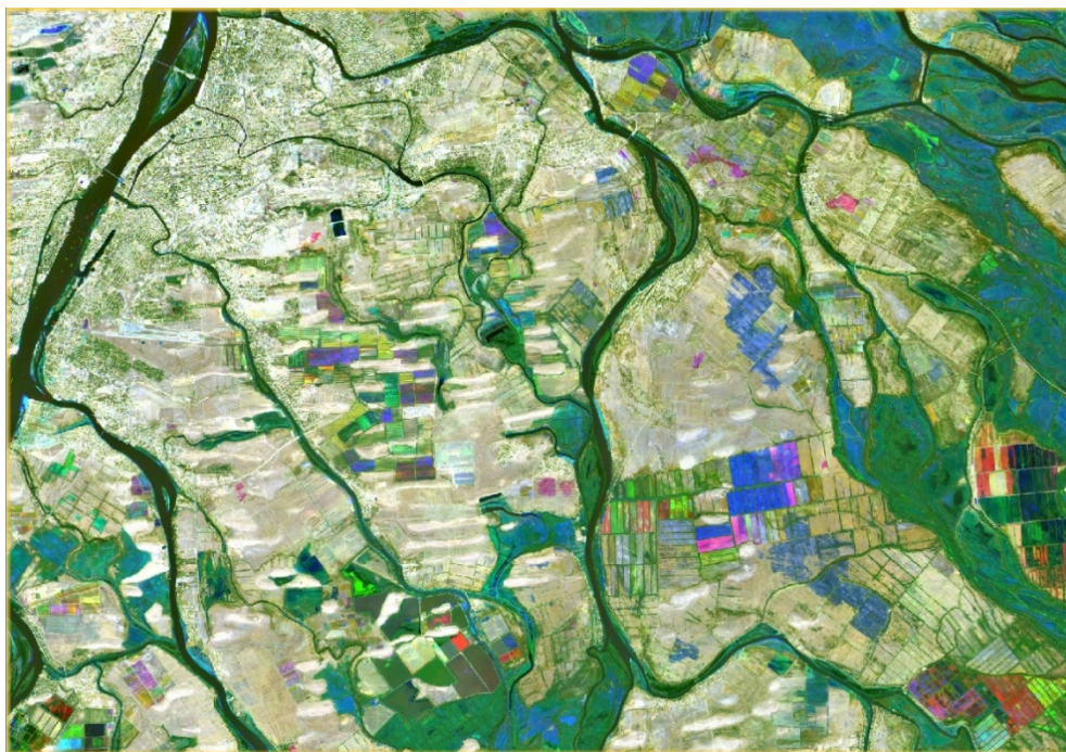
Рисунок 3. Цветовой синтез разносезонных снимков Sentinel 2, территория Приволжского района Астраханской области, входящий в центральную часть дельты реки Волга а – R-канал, конец весны, б – G-канал, середина лета, в – В-канал, начало осени; г – синтезированное изображение
