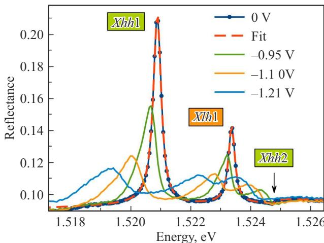
**Рис. 2.** Спектры экситонного отражения при дополнительном возбуждении ниже экситонных резонансов КЯ с мощностью накачки  $P = 30$  мкВт и различных электрических напряжениях. Энергии экситонных резонансов в отсутствие напряжения:  $E_{Xhh1} = 1.5209$  эВ,  $E_{Xlh1} = 1.5233$  эВ,  $E_{Xhh2} = 1.5248$  эВ. Штриховой красной кривой показана подгонка спектров отражения в рамках модели диэлектрического отклика [21]. (Цветной вариант рисунка представлен в электронной версии статьи).
