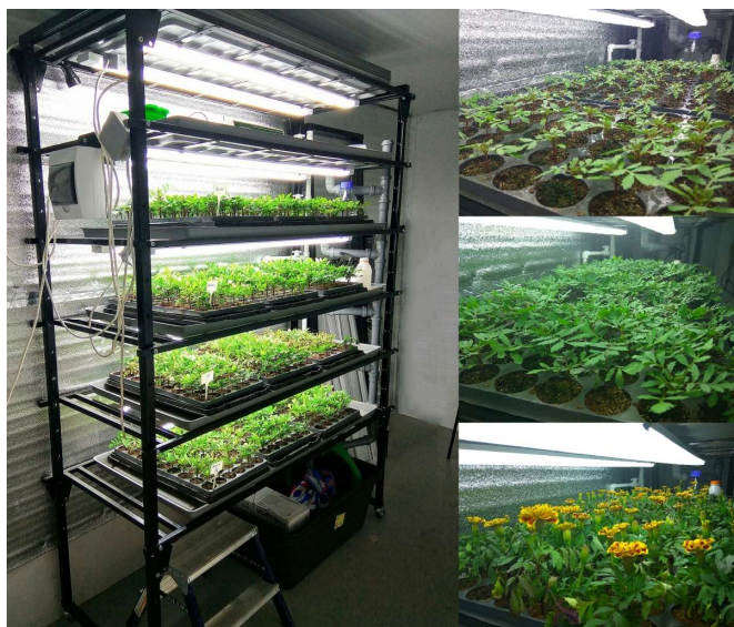
Рисунок 1. Автоматизированная многоярусная фитоферма для проведения научных опытов с лекарственными эфирносами в условиях гидросветокультуры защищенного грунта
