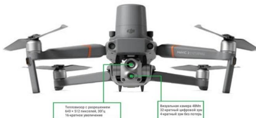
Рис. 1. Квадрокоптер DJI Mavic 2 Enterprise Advanced (с тепловизором)
