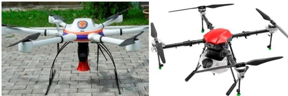
Рис. 6. Квадрокоптеры, оснащенные электрошоковым устройством и газовым распылителем
