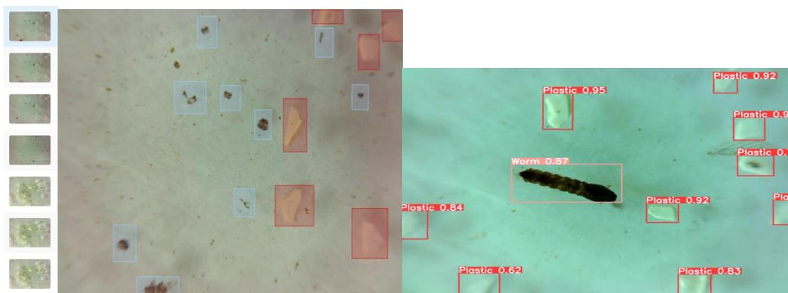
Рисунок 1 – Графический интерфейс пользователя модели YOLOv5 во время разметки образцов микропланктона и микропластика и результат распознавания изображения обученной моделью
