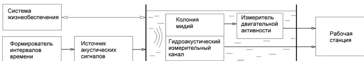
Рисунок 1 – Структурно-функциональная схема лабораторной установки
