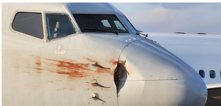
Рисунок 1 – Повреждение носовой части Boeing 737-800 [4]
