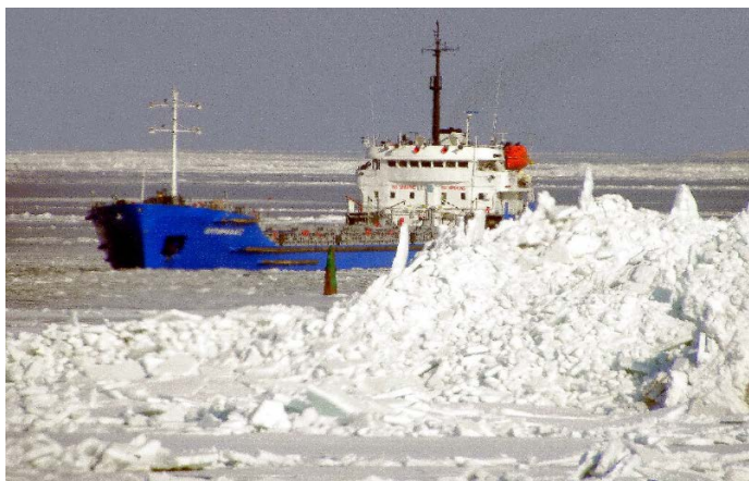
Рисунок 2 – Стамуха, образовавшаяся в ложе канала. На заднем плане судно и «сигара» - зимний навигационный буй, обозначающий фарватер (фото: ФГБУ «АМП Каспийского моря»)
