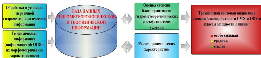
Рисунок 1 - Схема автоматизированного расчета динамических характеристик и определения степени благоприятности образования лавины
