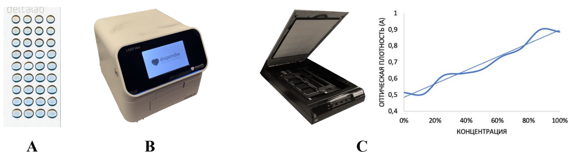
Рис. 1. А Чип с нанесенным БСА и реактивом Бредфорда; В Диспенсер I-Dot; С Система анализа: сканнер высокого разрешения и алгоритм обработки данных
