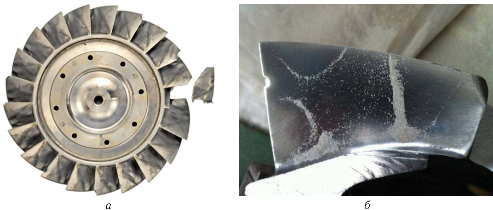
Рис. 1. Пример разрушения лопатки диска компрессора в эксплуатации (а) и результат исследования на собственные частоты (б) [3]
