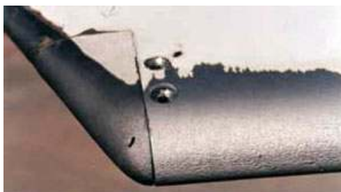
Рис. 1. Эрозионный износ лопасти вертолета
