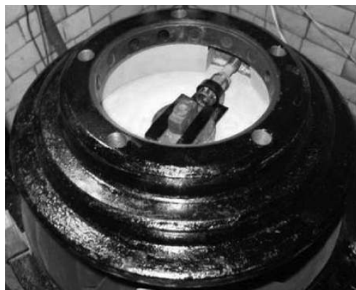
Рис. 1. Схема и фотография экспериментального стенда: 1 — образец СТТ; 2 — электровоспламенитель; 3 — подвижный локализатор зоны горения; 4 — вал; 5 — дискообразная камера сжигания; 6 — прозрачная крышка; 7 — шарнирная опора; 8 — направляющая; 9 — подставка; 10 — видеорегистратор; 11 — центральное отверстие; 12 — электропровода
