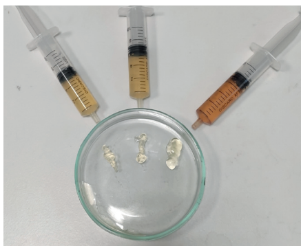
Рисунок 2. Гель на основе БСА с добавлением имидазола, имидазола (выдержанный в термостате), орнидазола (слева направо)
