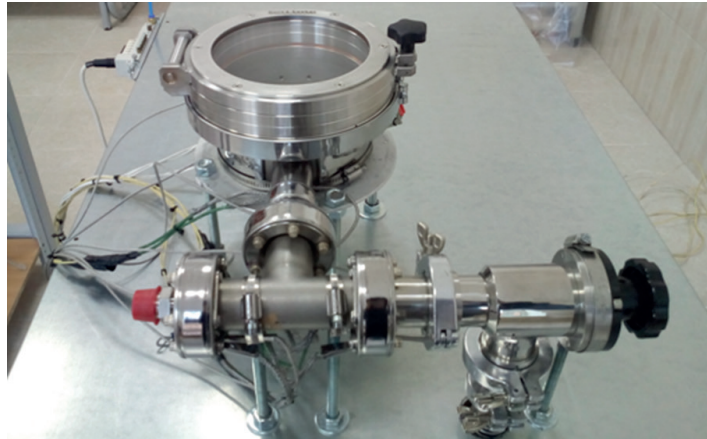
Рисунок 1. АСО реактор, внутри которого находились шариковые фильтры для очистки питьевой воды нанесения для покрытия
