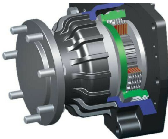
Рисунок 1 – Схема строения «мокрых» тормозов
