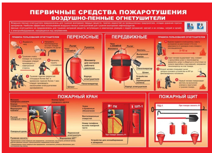
Рисунок 1 – первичные средства пожаротушения.
