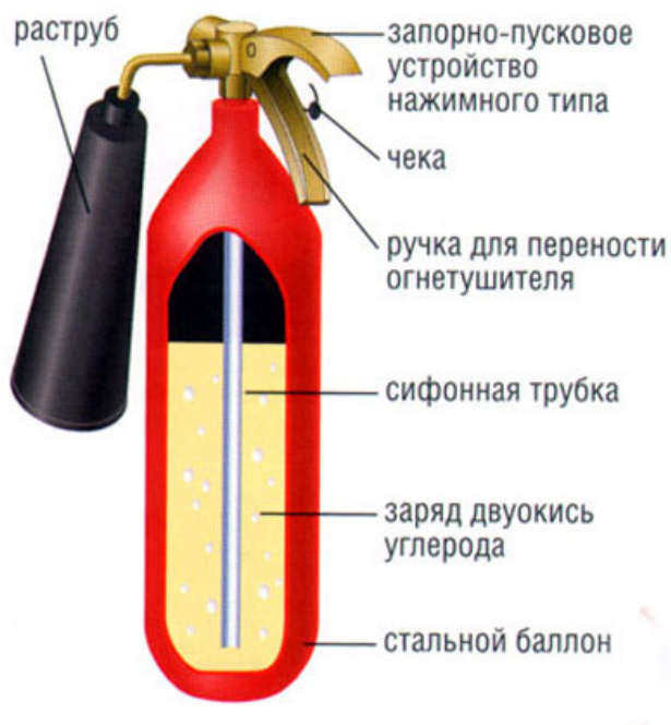
Рисунок 1 – конструкция углекислотного огнетушителя.
