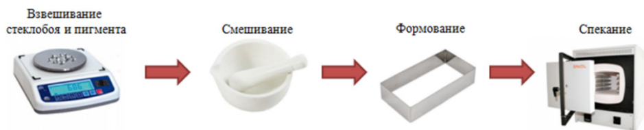
Рис. 1. Технологическая схема производства мозаичного стекла
